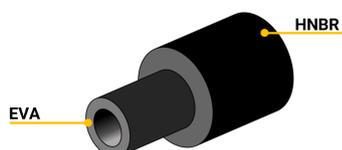
La durite bi-matière est polyvalente, elle s'applique sur tous les systèmes d'injection, toutes générations confondues. La paroi intérieure est plus tendre que l'extérieure, ce qui lui permet d'envelopper les plots de raccordement des connecteurs.
